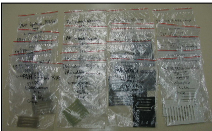
Obr. 28. Zkušební tělesa připravená k ozáření
