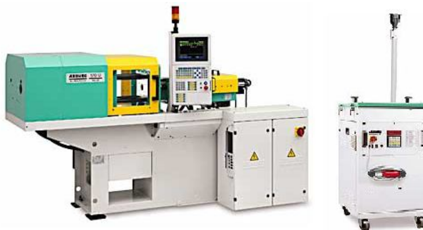
Obr. 27. Vstřikovací stroj ARBURG Allrounder 170 U a sušící zařízení ARBURG THERMOLIFT 100-2 [25]
