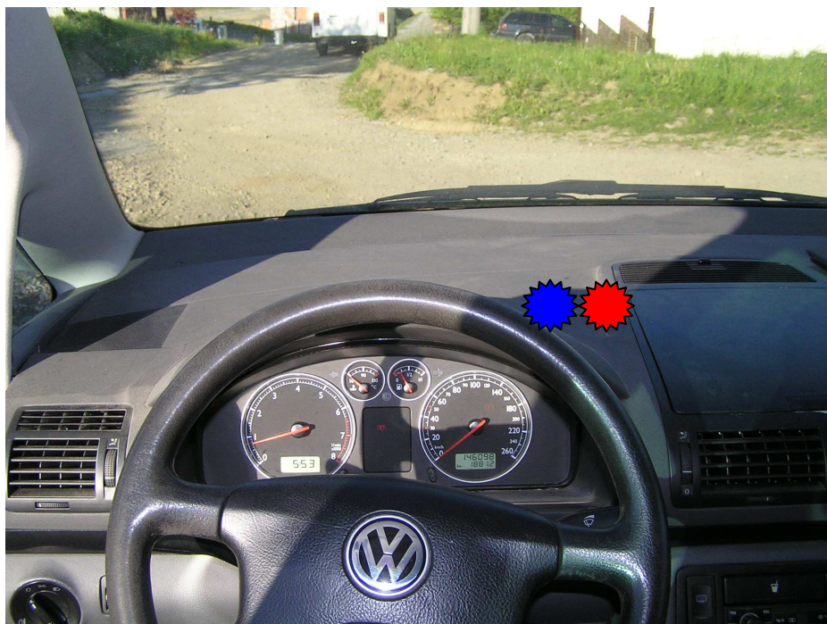
Obr. 12. Upozornění řidiče světelnou návěstí v kabině vozidla na blížící se vozidlo IZS
