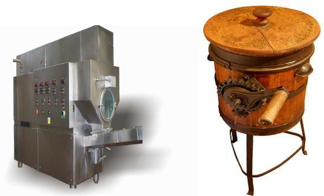
Obr. 4. Kontinuální (vlevo) a diskontinuální zmáselňovače [61, 62]
