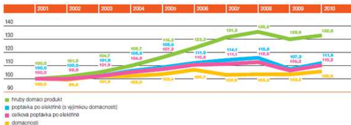
Obr. 5.3 Porovnání vývoje HDP a poptávky po elektřině v ČR – index 100 % = rok 2001 (Zdroj: Čez, ©2005)
