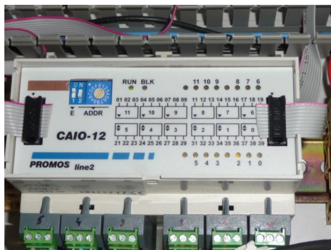
Obrázek 19 CAIO 12 – periferní jednotka na sběrnici CANopen
