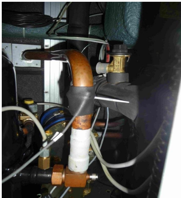
Obrázek 21 Připevněné teplotní čidlo – dotykový teploměr
