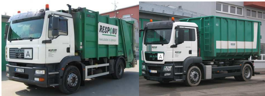
Obr. 9. Svozové vozidlo MAN a vozidlo MAN s kontejnerem 20 m 3 . (Respono, 2012b)
