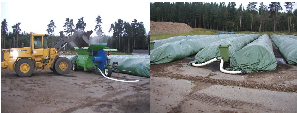
Obr. 23. Systém kompostování v AG-Bag vacích. (CRS Marketing, 2012)
