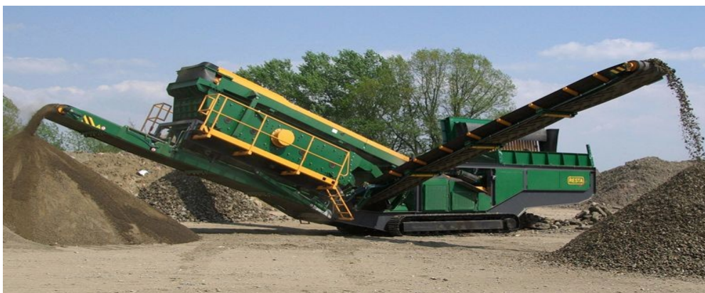
Obr. 3: Mobilní třídící jednotka RESTA TH2 1600x4000/2 na pásovém podvozku
