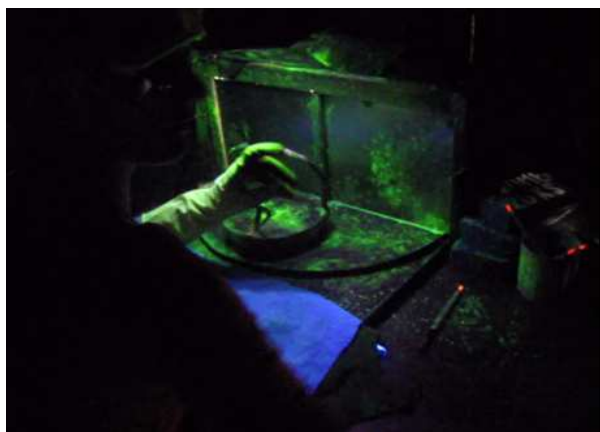
Obr. 42 Kontrola trhlin - operace B
