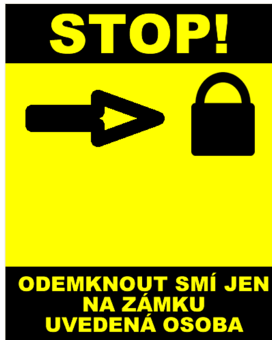
Obrázek 16 Provedení značky umístěné na zařízení s ochranou před nebezpečnými energiemi [2]
