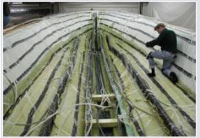
Obrázek 15 Výroba trupu lodě metodou vakuového prosycování [2]
