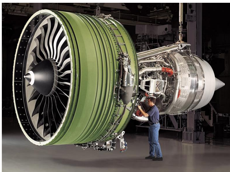
Obr.12 Letecký motor GE90-115B. Lopatky jsou vyrobeny ze 700 vrstev uhlíkových vláken v epoxidové matrici
