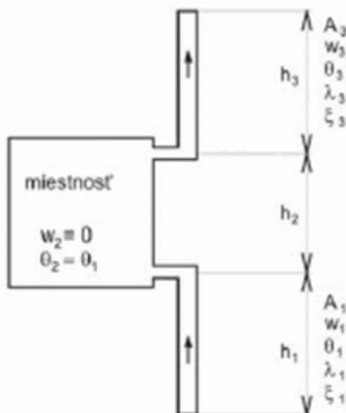
Obr. 7 Schéma šachtového vetrania [10]
