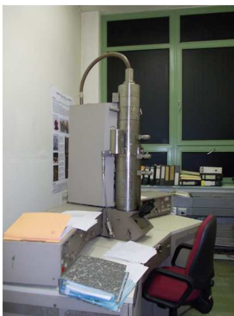
Obr. 24 – Transmisní elektronový mikroskop TESLA BM 500
