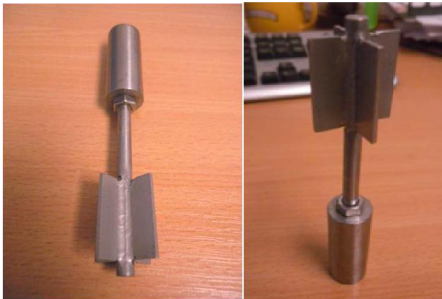
Obr. 11. Speciální nástavec pro měření rheologických vlastností pro gelovité materiály.
