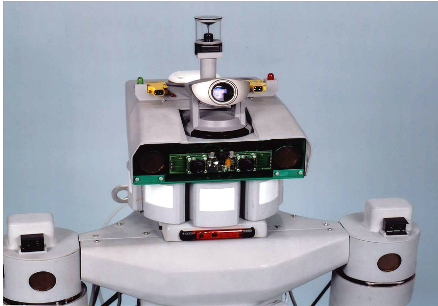
Obr. 18. Robot je vybavený vizuálnou kamerou umiestnenou na hlave a tiež pasívnym infračerveným čidlom okolo krku a detektorom pohybu za lícnou doskou
