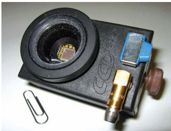
Obr. 6. Prvá čas. ČB CCD kamera (bez objektivu) TESLA PTK 0256 (r. 1984)
