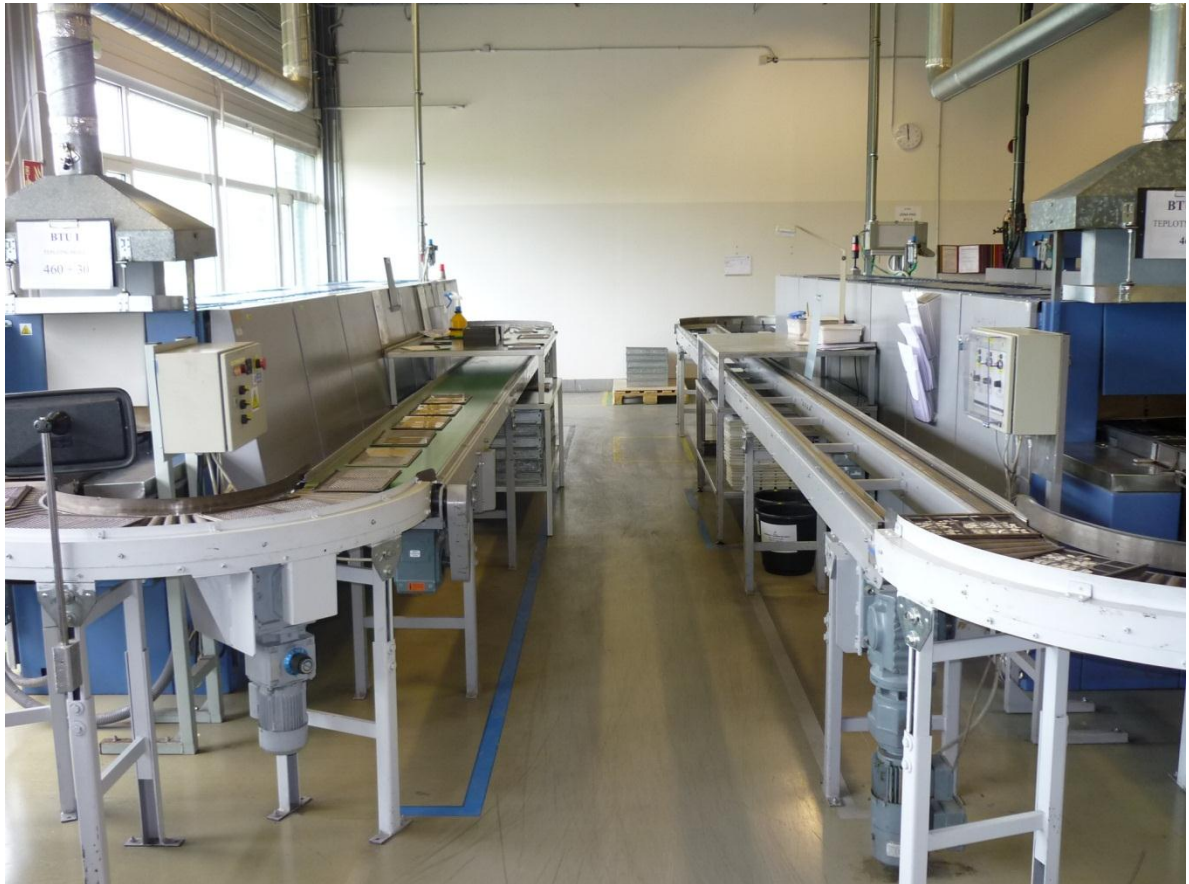
Obrázek 21: Náhled pracoviště výpal po metalizaci. (Vlastní)
