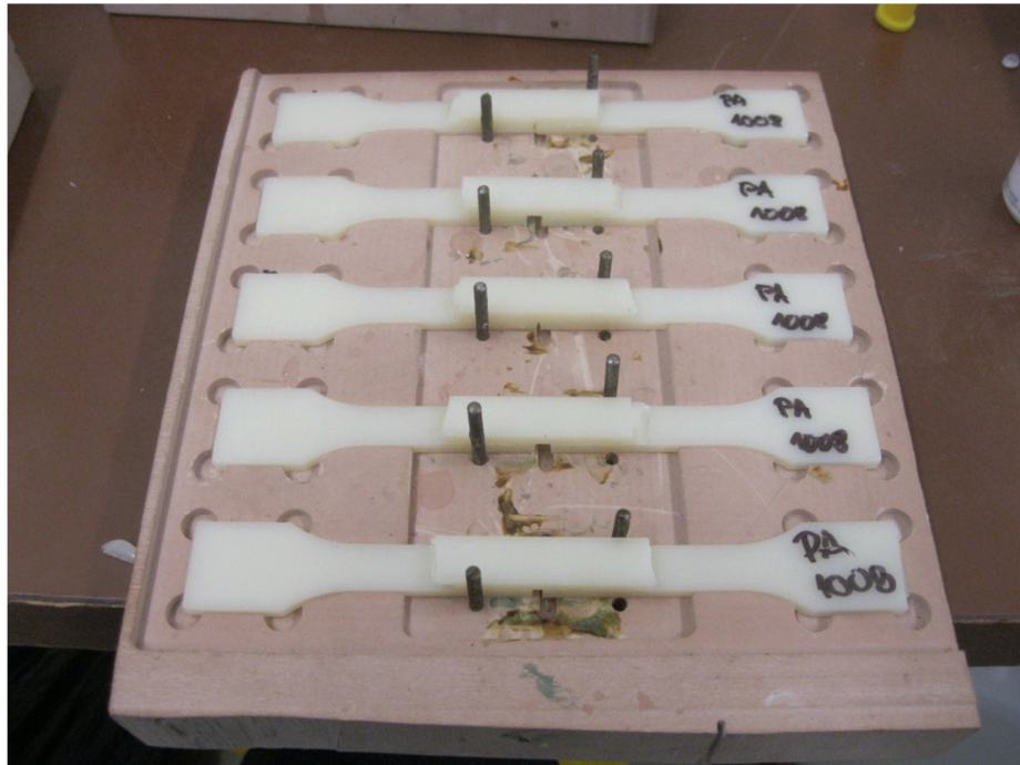
Obr. 25. Příklad lepení polyamidu lepidlem Cyberbond 1008.
