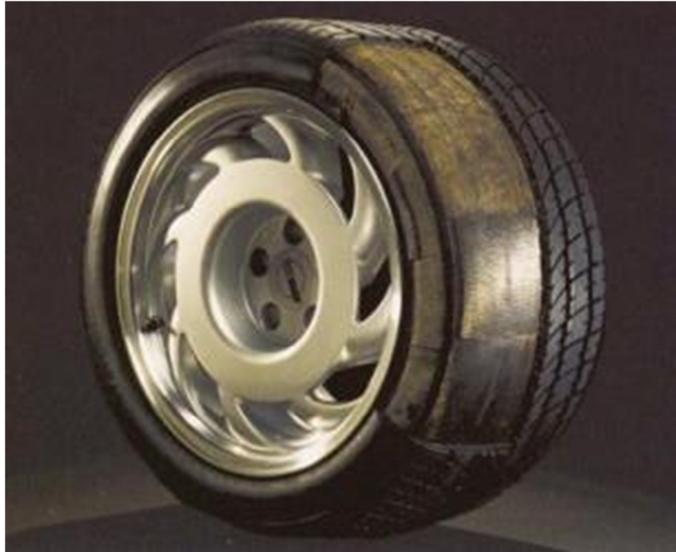
Obr. 3. Kord pneumatiky vyztužený aramidovými vlákny Kevlar. [2]
