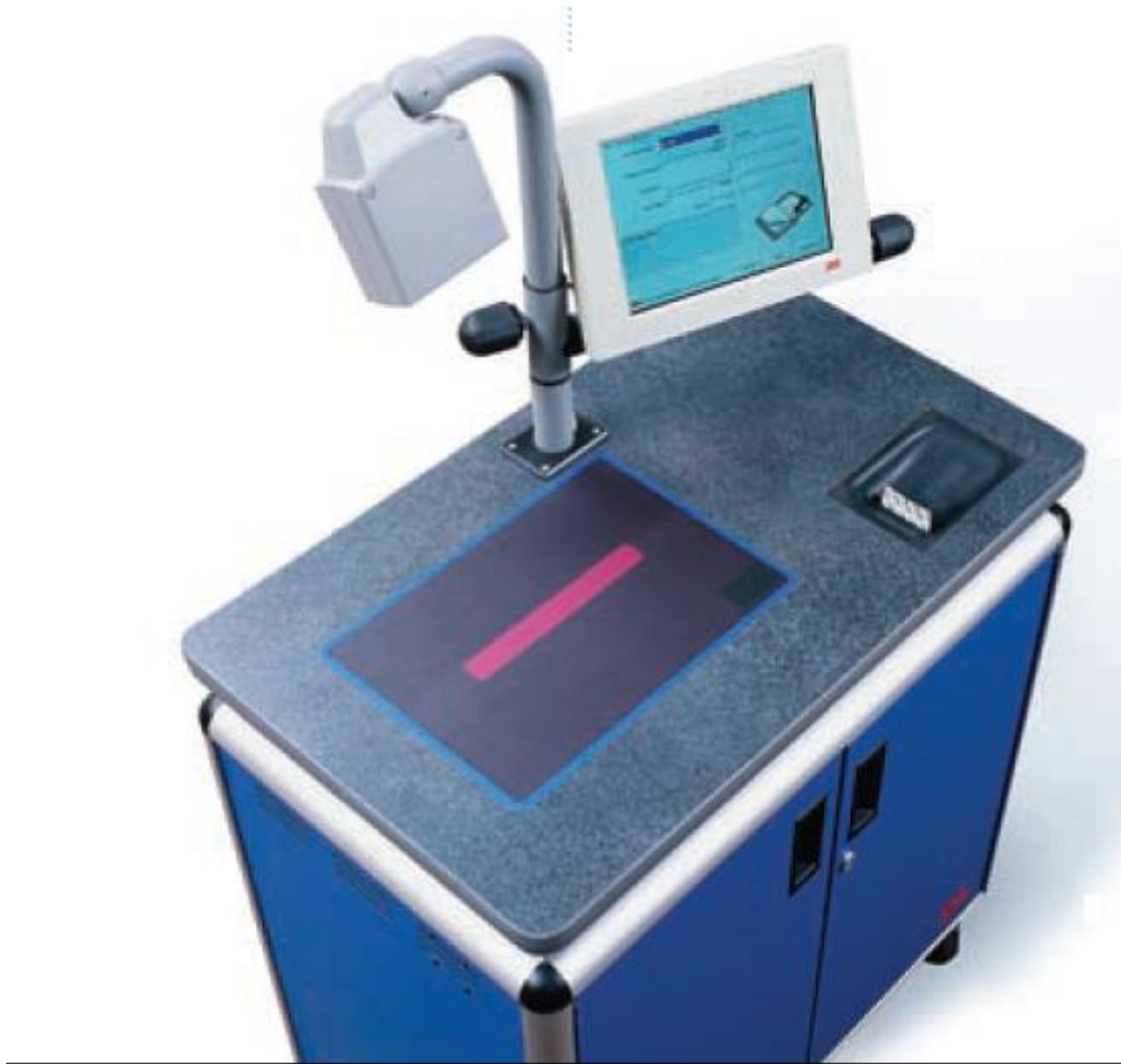
Obrázek 13 Adaptační stanice pro převod čárových kódů do čipů RFID [31]
