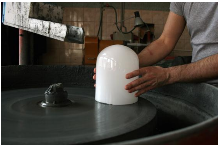
Obr. 76. Zabrušování na hladině
