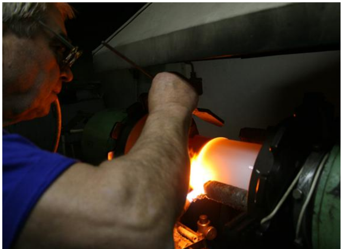
Obr. 80. Svařování na sklářském soustruhu
