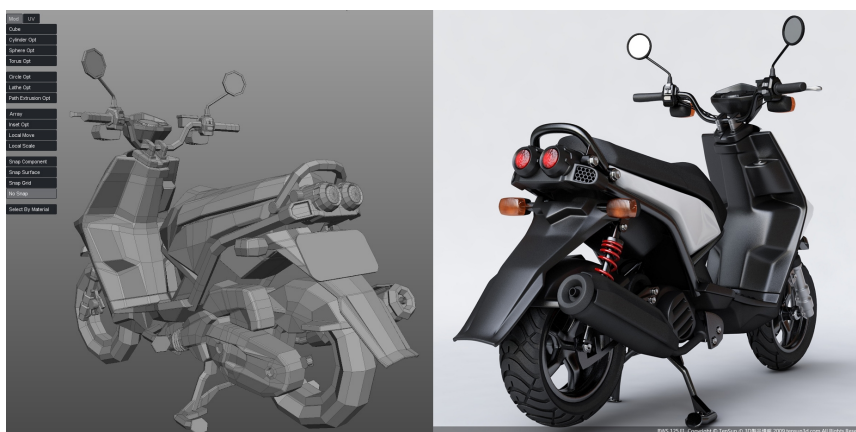
Obr. 14: 3D model motocyklu vytvořený v programu Silo. Autor uvádí, že na zhotovení potřeboval pouhých 25 hodin. http://www.silo3d.com/forum/showthread.php?t=16648
