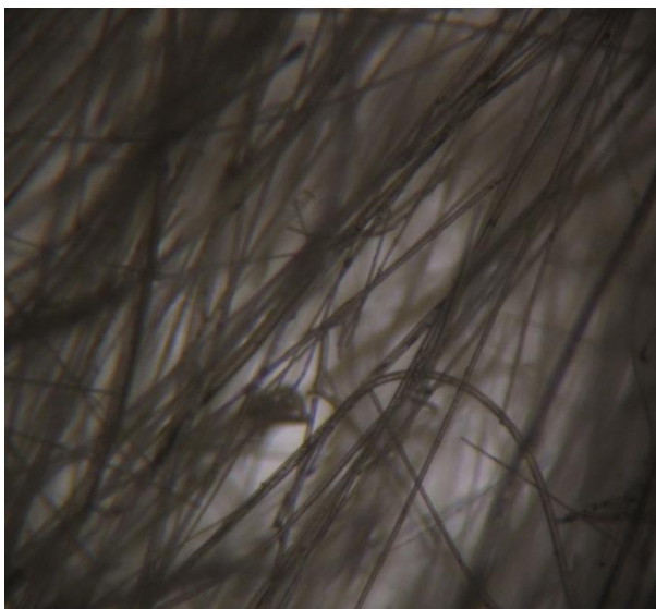
Obr. 16. Struktura skelné vaty s netkanou rohoží, zvětšeno 40×, dolní osvit
