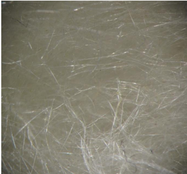
Obr. 15. Povrch skelné vaty s netkanou rohoží, zvětšeno 16×, horní osvit
