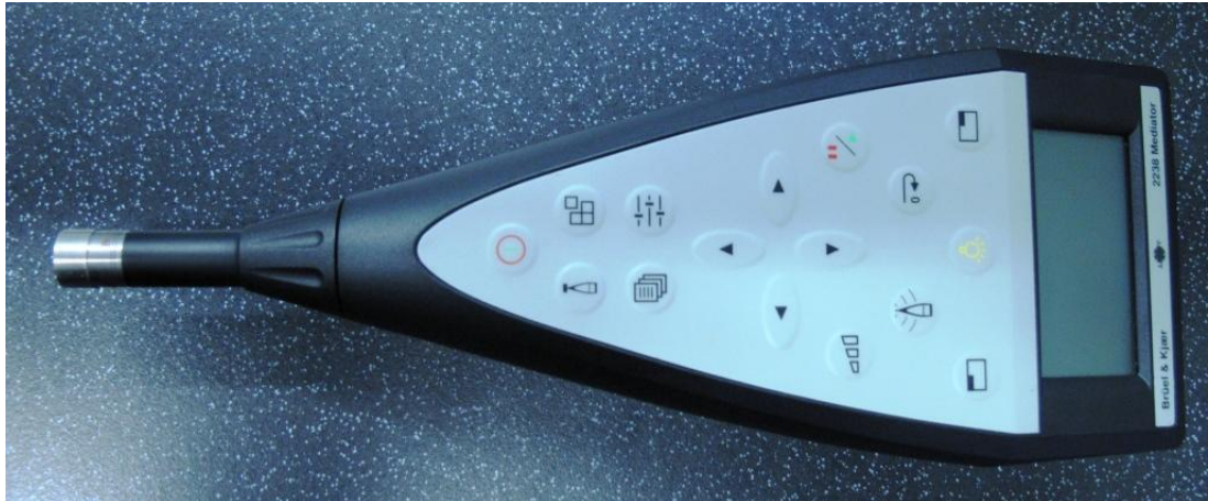
Obr. 5. Analyzátor hladiny akustického tlaku Brüel & Kjær 2238 Mediator
