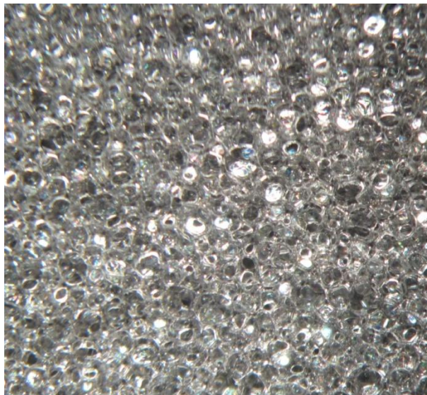
Obr. 8. Povrch černého polyuretanu S 3535 F, zvětšeno 8×, horní osvit
