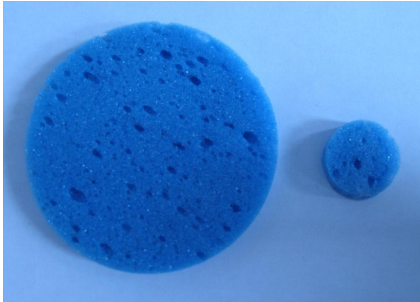
Obr. 7. Vzorky modrého polyuretanu N 2200 pro měření koeficientu zvukové pohltivosti o velikosti 100 a 30 mm
