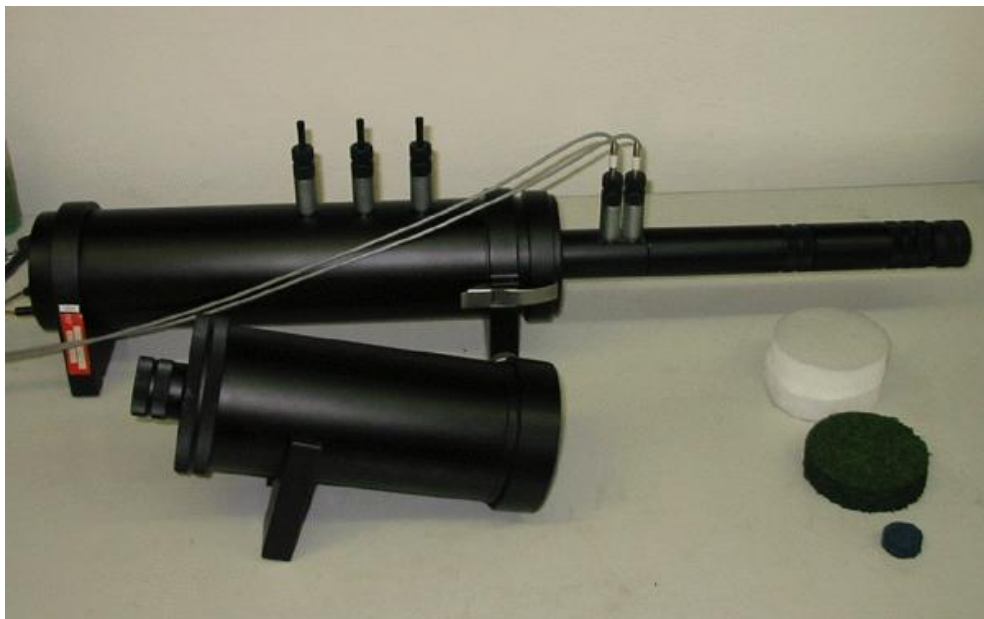
Obr. 4. Dvou-mikrofonová impedanční trubice Brüel & Kjaer typ 4206 [12]
