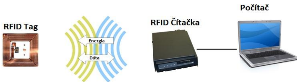
Obr. č. 1 Princíp RFID systému
