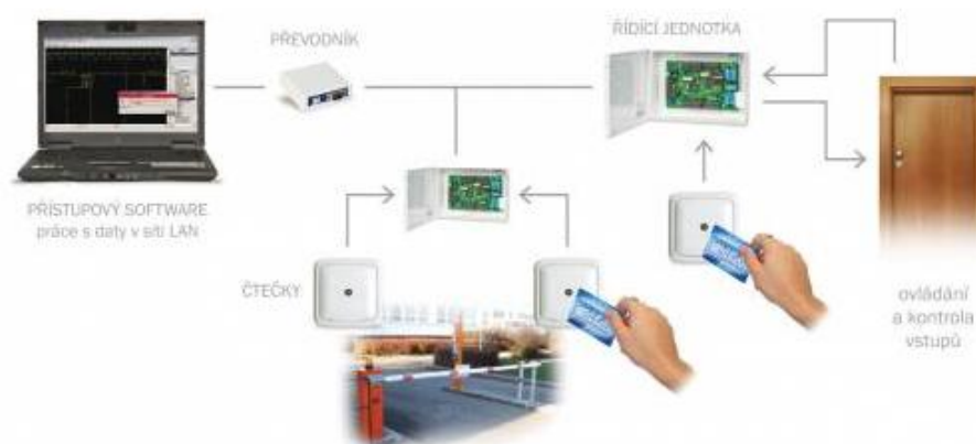
Obr. č. 24 Princíp prístupového systému [7]
