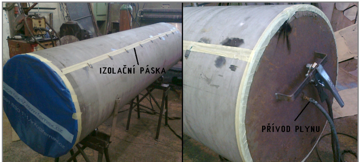
Obr. 42 Postup ochrany kořene svarové lázně
