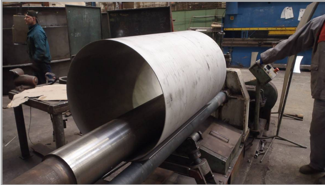
Obr. 27 Skružování válcového pláště - vykulacení
