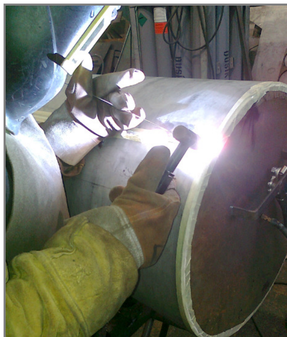
Obr. 43 Svařování pláště (metoda 141)
