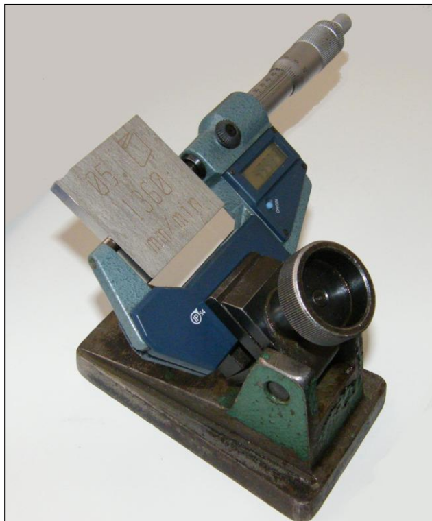
Obr. 30 Měření mikrometrem Mitutoyo
