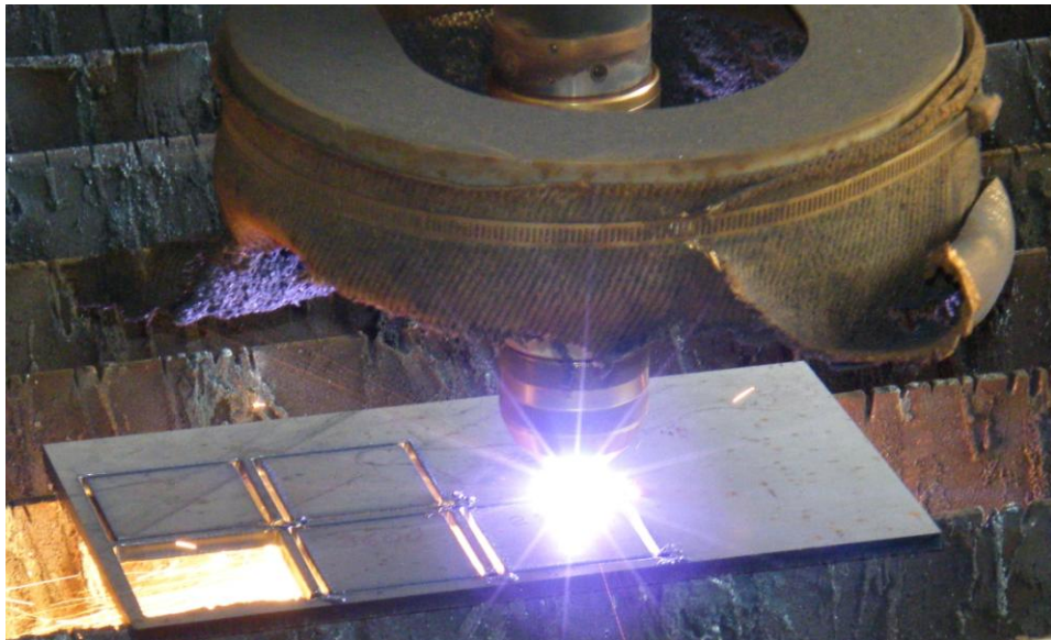
Obr. 32 Obrábění oceli 11 375 plazmovým paprskem
