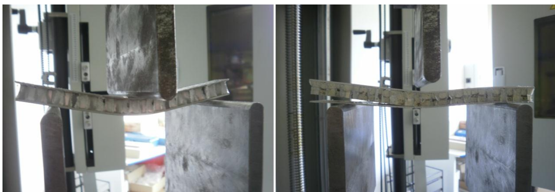
Obr. 25. T íbodový ohyb
