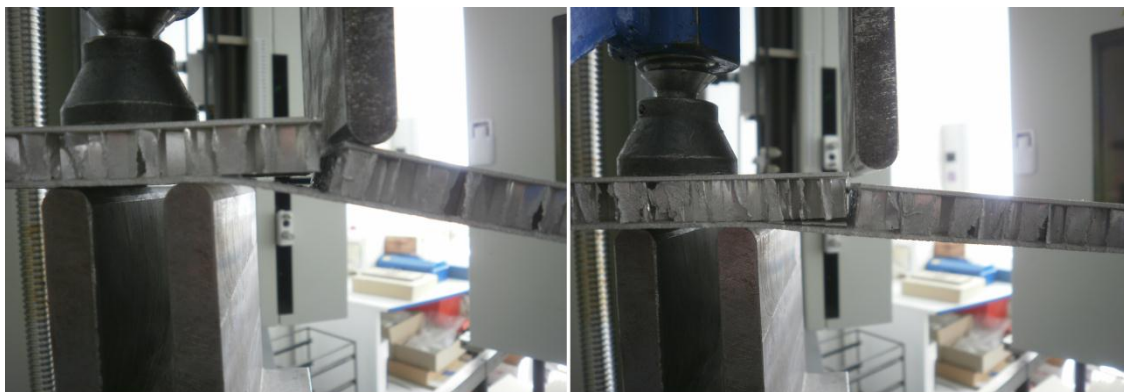
Obr. 27. Zkouška odlupem - před zátěží, po zátěží
