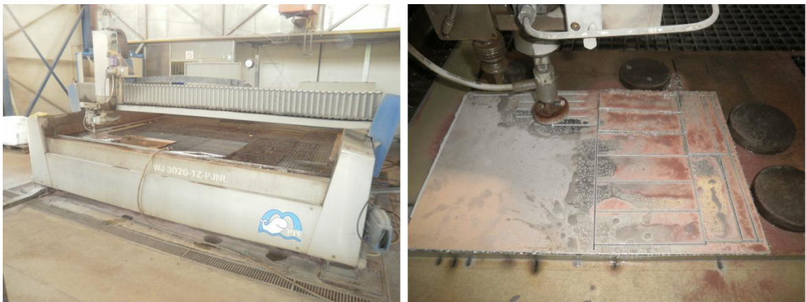
Obr. 23. ezání abrazivním vodním paprskem
