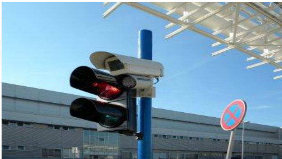
Obr. 41 Kamera DataCam v klimaticky odolném pouzdru [32]
