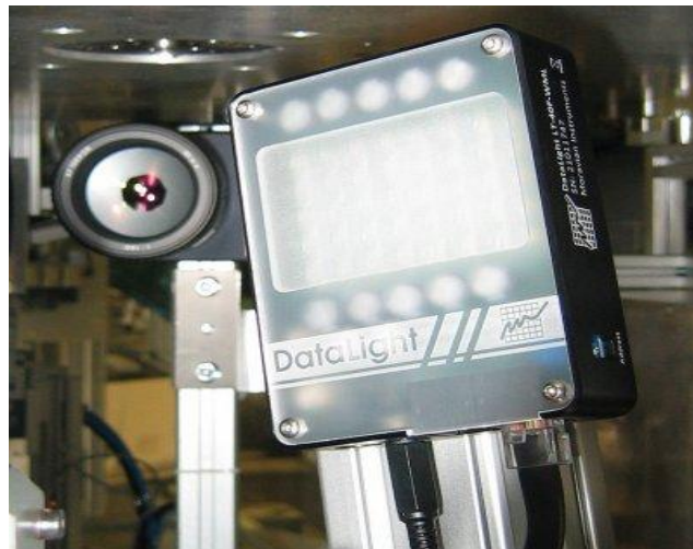
Obr. 40 Umístění zábleskového osvětlovače ve stroji [31]
