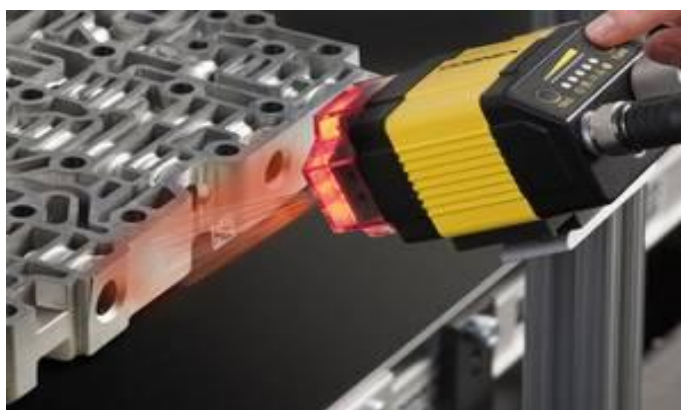
Obr. 43 Snímač kódů DataMan [33]
