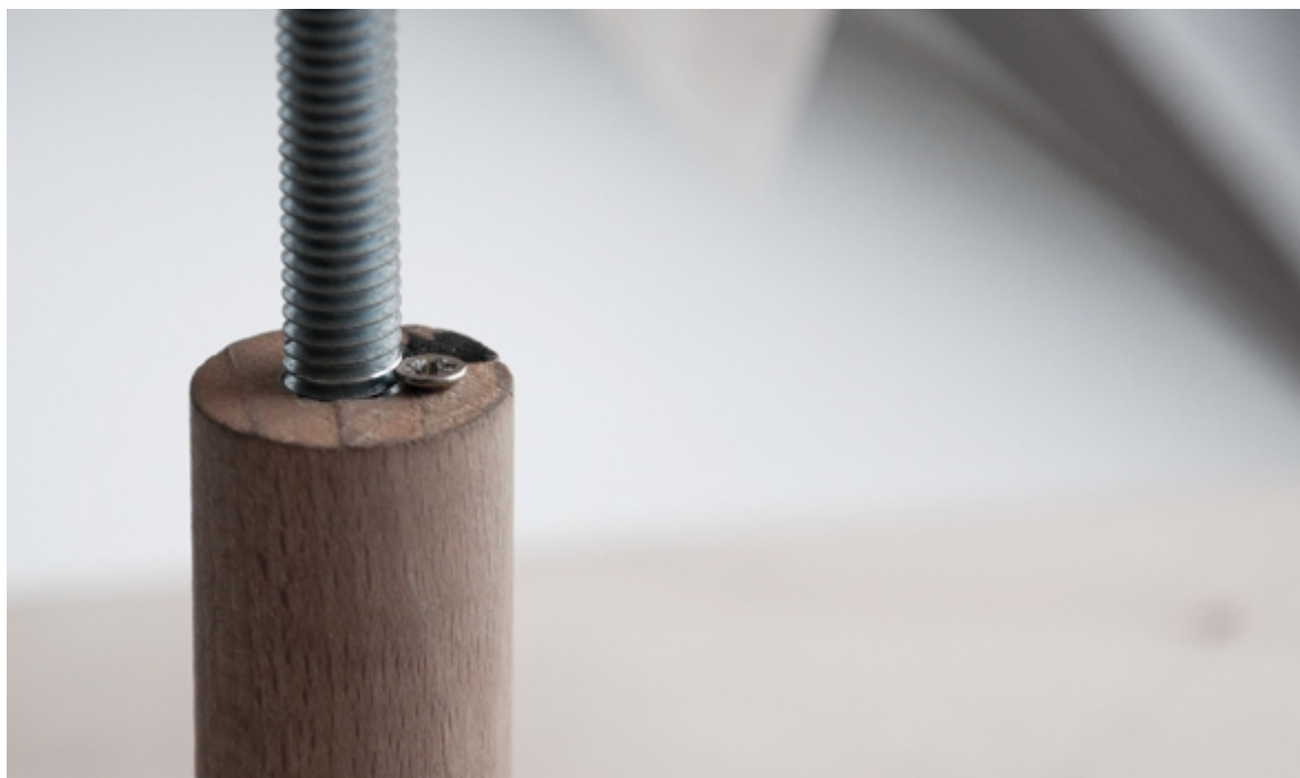
Obr. 12. Podstavec, na ktorom je vytvorený závit
