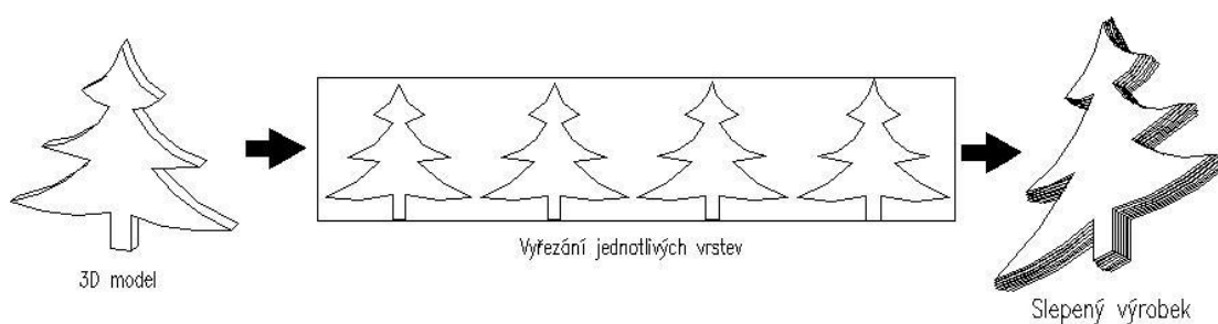
Obr. 13 Postup výroby metodou LOM
