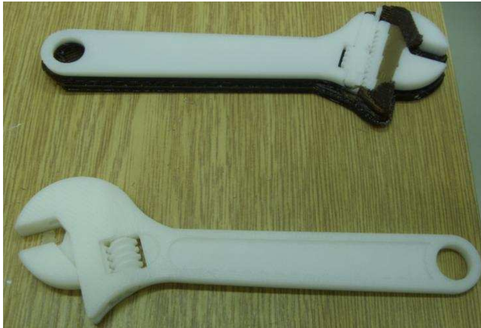
Obr. 9 Výrobek vytvořený metodou Rapid Prototyping
