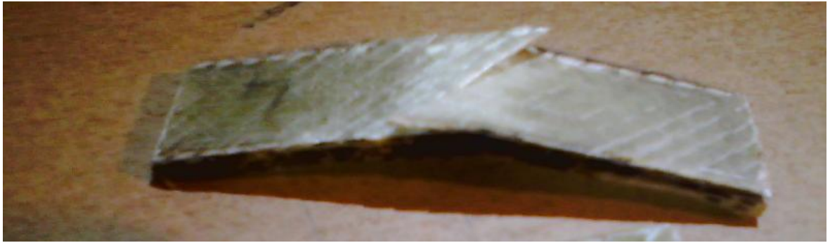
Obrázek 38- Zkušební těleso laminátu z biaxiální tkaniny po zkoušce ohybem
