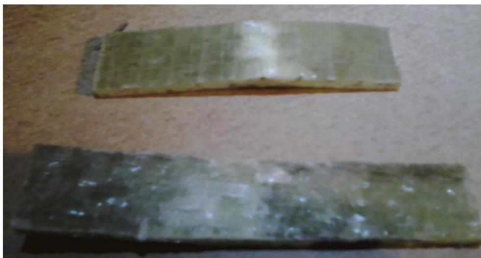
Obrázek 37- Zkušební těleso laminátu ze skelné tkaniny s tkanými pramenci po zkoušce
