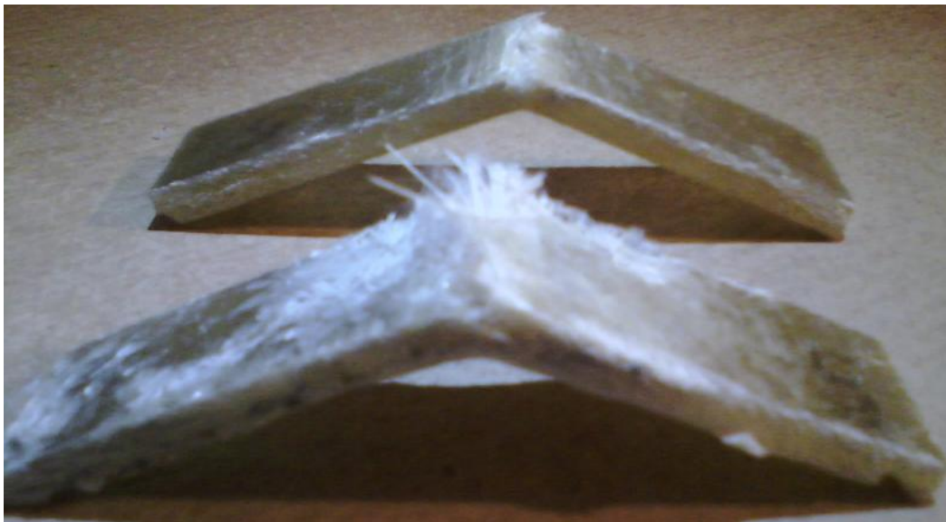
Obrázek 39- Zkušební těleso z laminátu ze skelné rohože po provedení zkoušky ohybem
