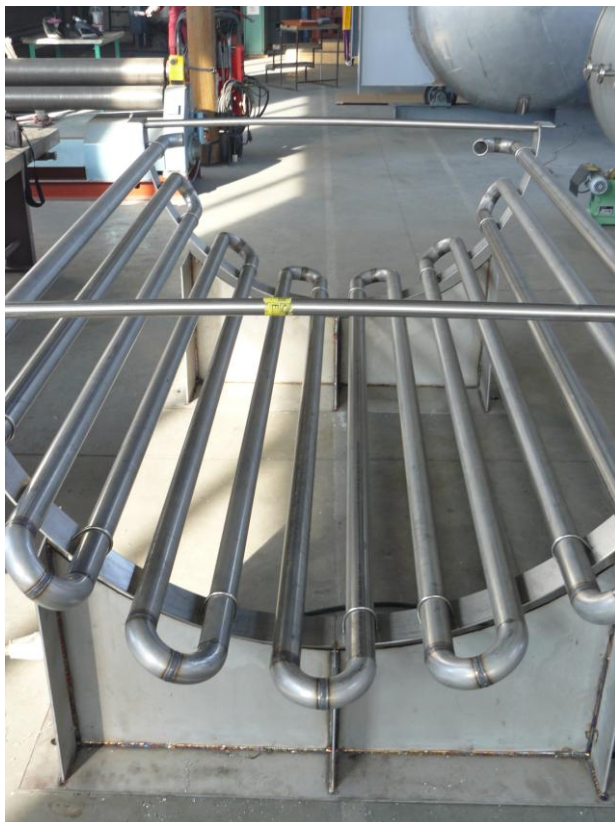
Obr. 69. Výroba trubkové výplně výměníku
