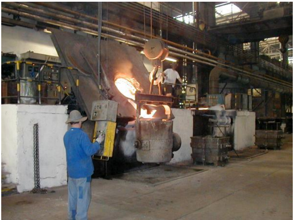
Obr. 9. Plnění přepravních nádob žhavým materiálem
