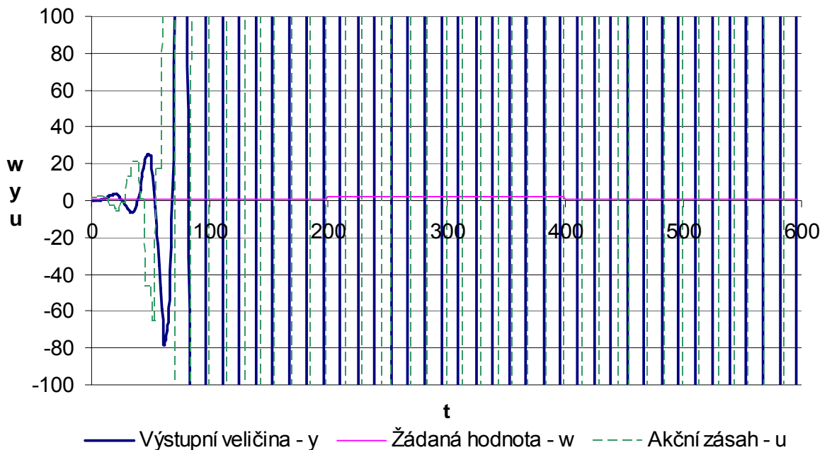
Obr. 6.21 Simulační průběh regulačního pochodu s použitím Takahashiho modifikace metody Z-N
