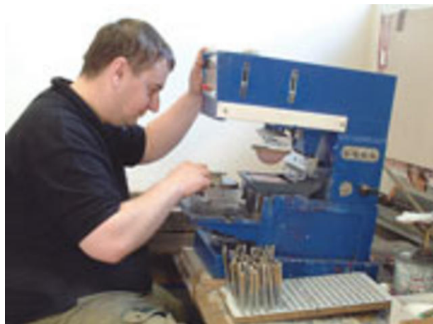
Obr. 18. Jednobarevný tamponový tisk
