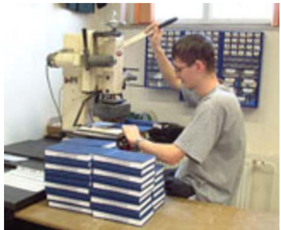
Obr. 24. Ražení za horka
