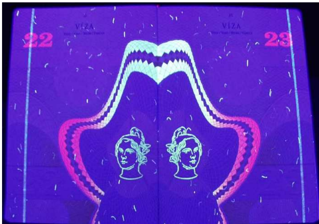
Obr. 13. Barvy s fluorescencí (zdroj: archiv STC)
