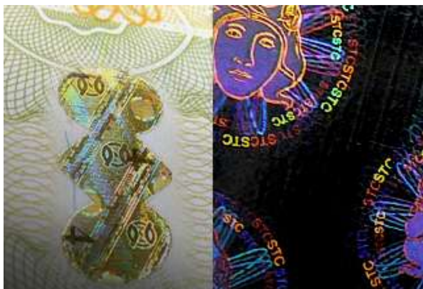
Obr. 9. Holografická fólie (zdroj: archiv STC)
