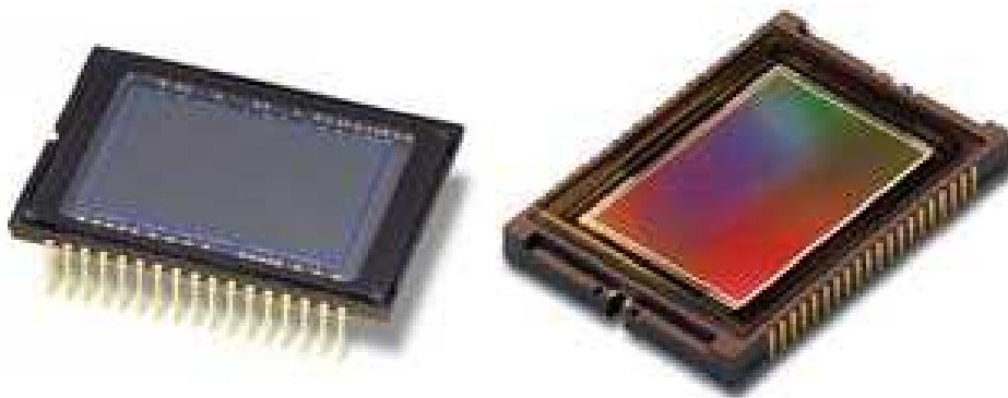
Obr. 11. CCD a CMOS snímací čip [10]
