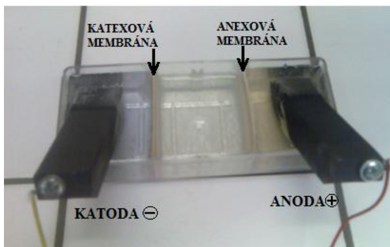
Obr. 6: Vytvořená aparatura pro měření zónové elektroforézy
