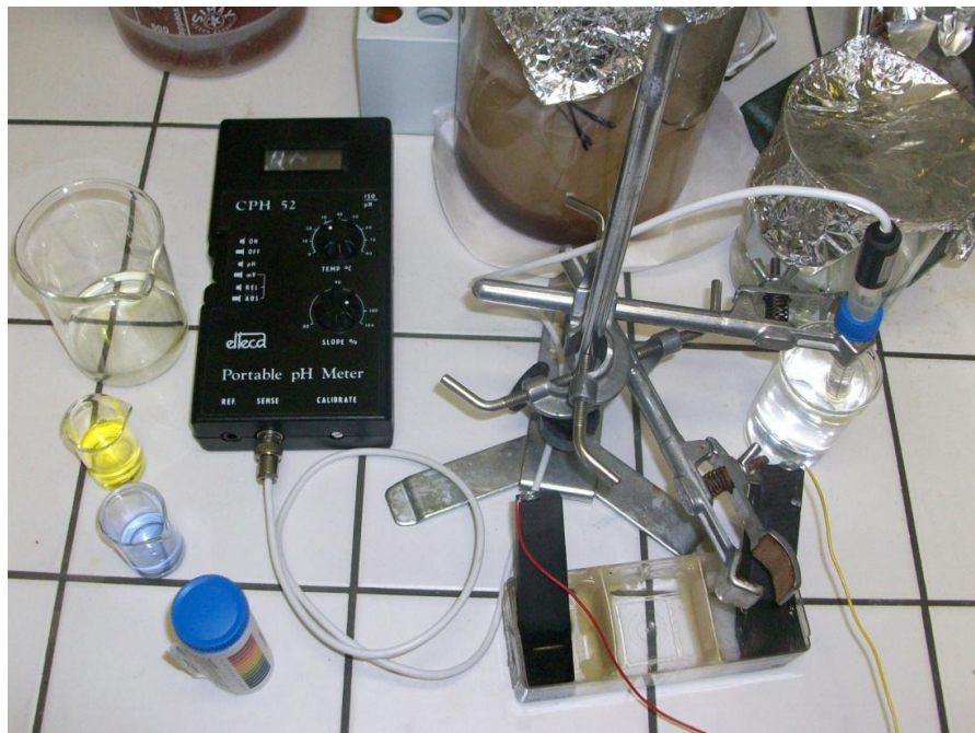
Obr. 7: Měřicí aparatura s digitálním pH metrem ELTECA CPH52
