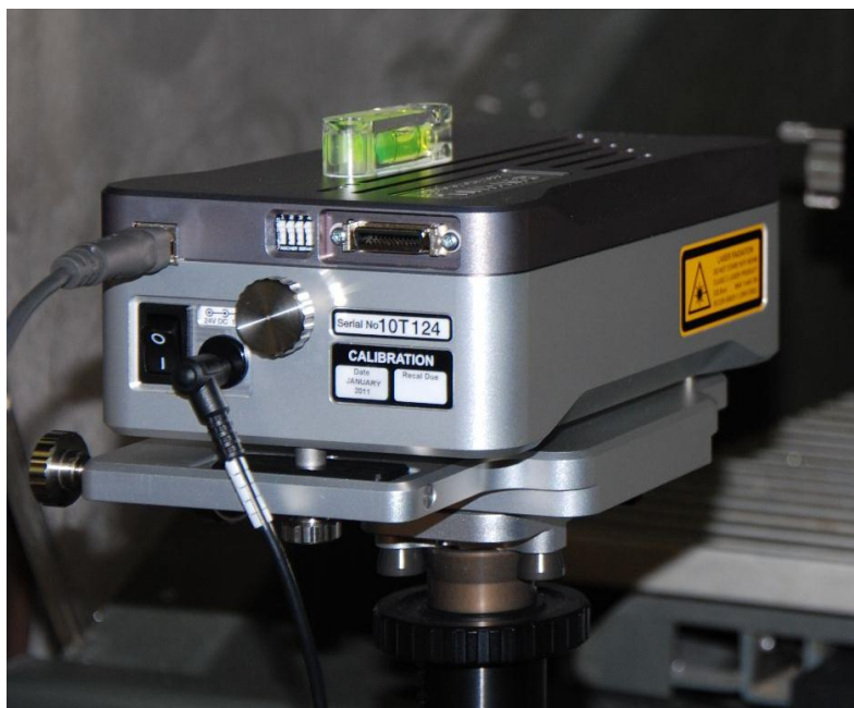
Obr. 30. Vyrovnání laseru vodováhou.
