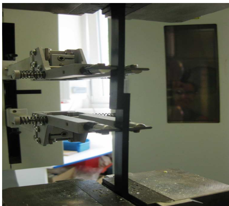
Obr. 19. Detaily trhacího zařízení při trhání
