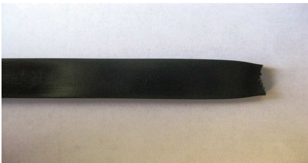
Obr. 24. Přetržený vzorek PA 66, který nebyl svařen
