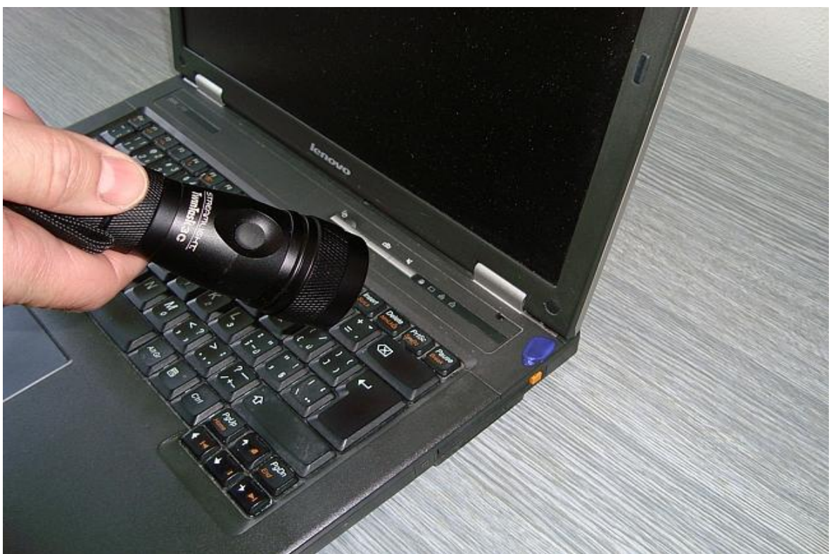
Obr. 31. Detekce nátěru pomocí UV světla
