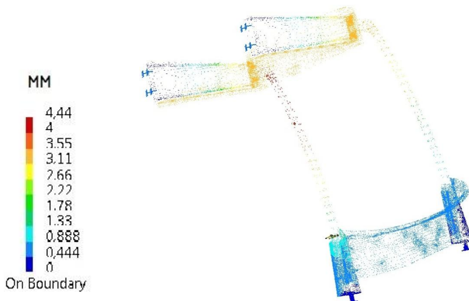
Obr 28 posunutí při 40kN z boku na rám
