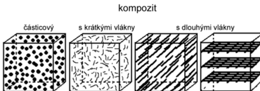
Obr 10 Geometrický tvar výztuže kompozitních materiálů[8]
