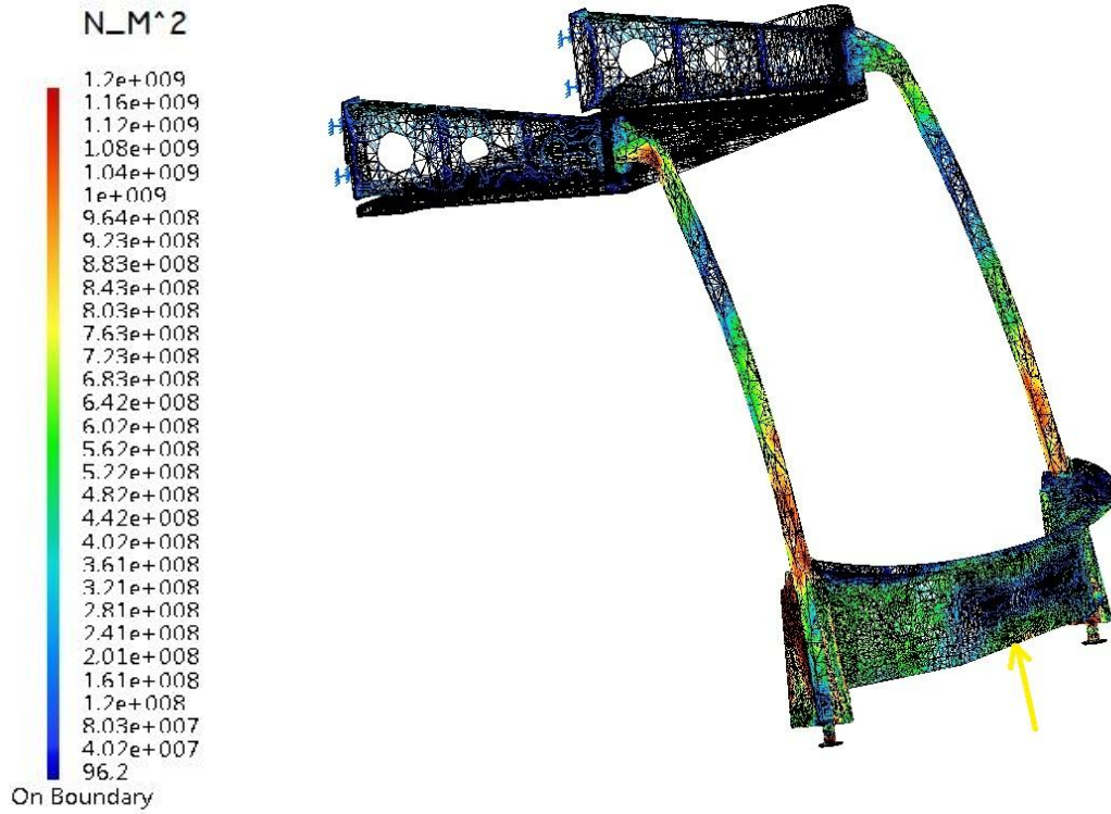
Obr 25 napětí způsobené 40kN na podokenní část
