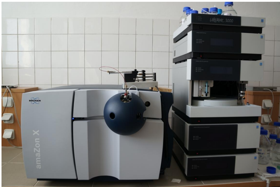
Vysokoučinný kapalinový chromatograf UltiMate 3000 (Dionex) spojený s hmotnostním spektrometrem s iontovou pastí amaZon X (Bruker Daltonics) vybaveným elektrosprejovým ionizačním zdrojem.
