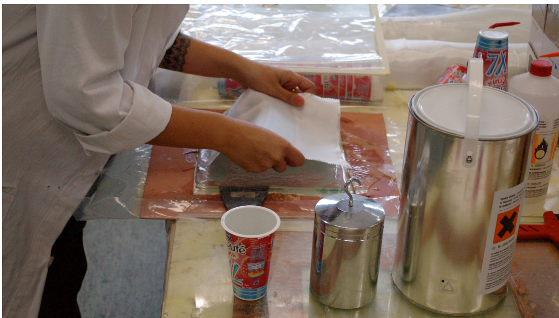
Obr. 48: Laboratórna príprava laminačných vzorkov, vlastné spracovanie
