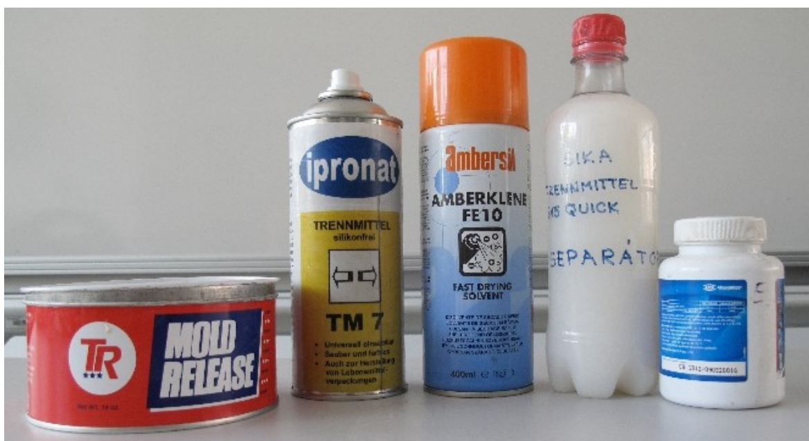
Obr. 126: A) Mold Release; B) Ipronat Trennmittel; C) Ambersil Amberklene FE10; D) Sika Trennmittel 815 Quick; E) Včelý vosk (3%) + Benzén, vlastné spracovanie
