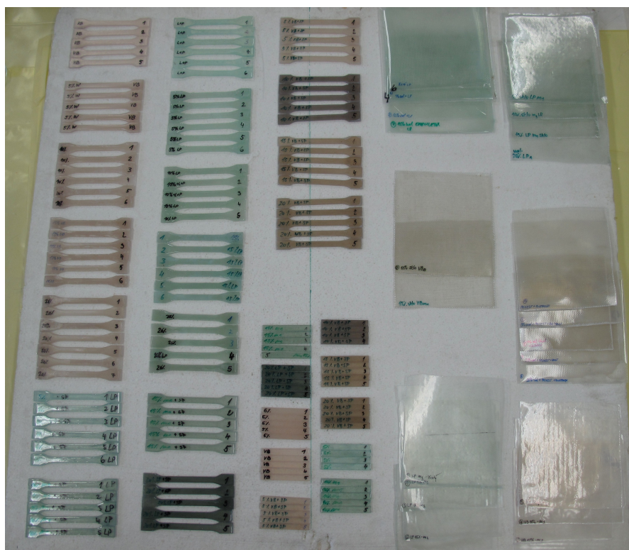
Obr. 37: Lopatky, tyčinky a lamináty pred ťahovou skúškou - kompletne vzorky pre realizáciu mechanických skúšok, vlastné spracovanie
