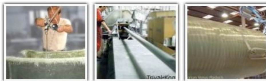
Obr. 10: Metóda výroby skleneného vlákna striekaním, ťahaním a navíjaním
