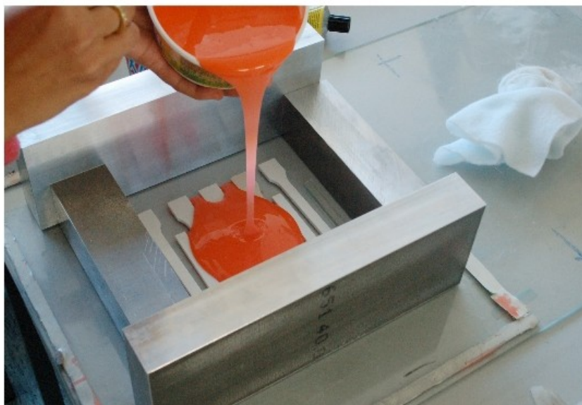
Obr. 122: Zalievanie teliesok pri výrobe formy, vlastné spracovanie
