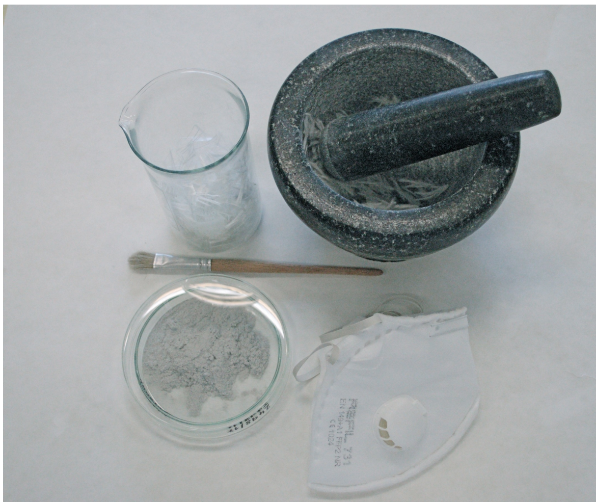
Obr. 15: Sklený prach a pomôcky na jeho laboratórnu výrobu, vlastné spracovanie
