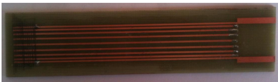
Comblin filtr se 7 rezonátory vyrobený pomocí expozice.
