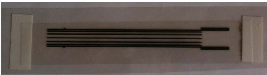
obr. 29: Fólie pro expozici Comblin s 5 rezonátory
