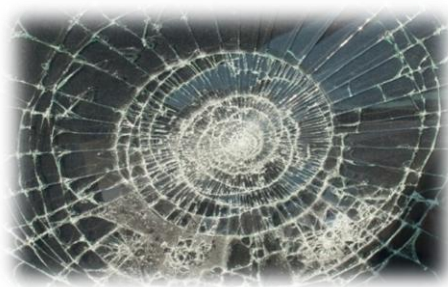
Obr. 36. Sklo po úderu opatřené bezpečnostní fólií. [29]
