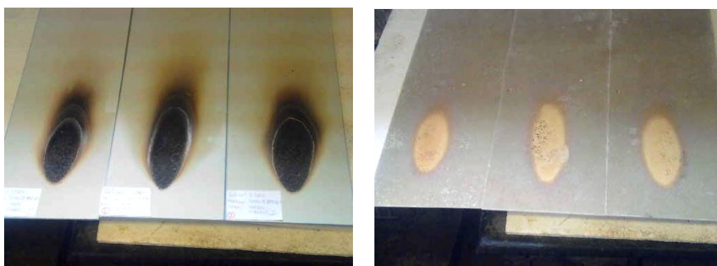
Obr. 17 Porovnání prohoření gelcoatu a pryskyřice vzorku č. 2
