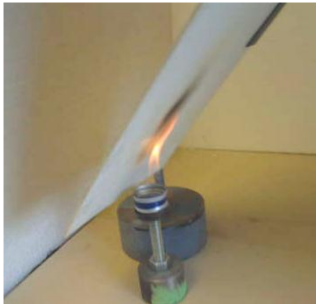
Obr. 8 Testovací metoda za použití kahanu
