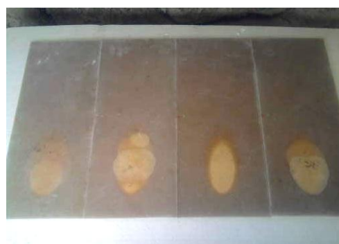
Obr. 21 Porovnání prohoření gelcoatu a pryskyřice vzorku č. 6
