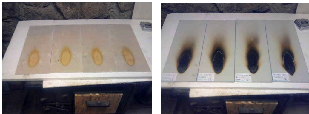
Obr. 19 Porovnání prohoření gelcoatu a pryskyřice vzorku č. 4
