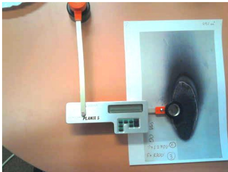
Obr. 23 Samotné měření žárem poškozené plochy
