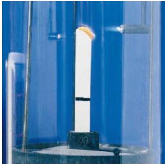
Obr. 6 Ukázka zkoušky metodou kyslíkového čísla „LOI“ [3]
