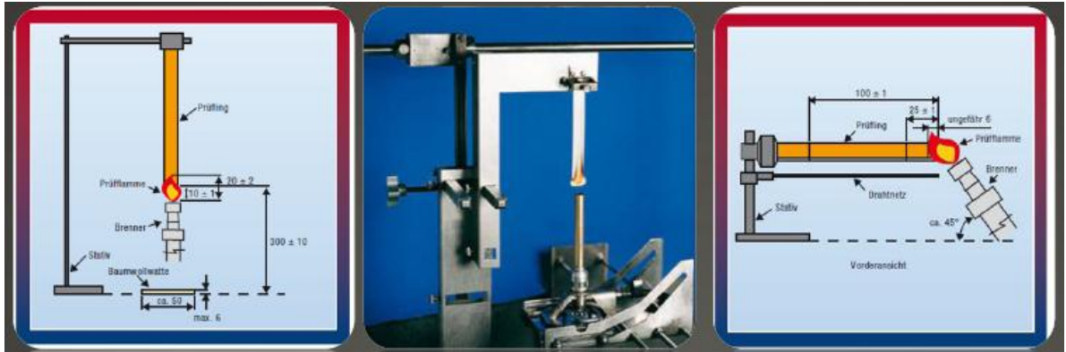
Obr. 7 Ukázka uspořádání testovací metody UL 94 [5]
