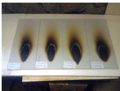
Obr. 18 Porovnání prohoření gelcoatu a pryskyřice vzorku č. 3
