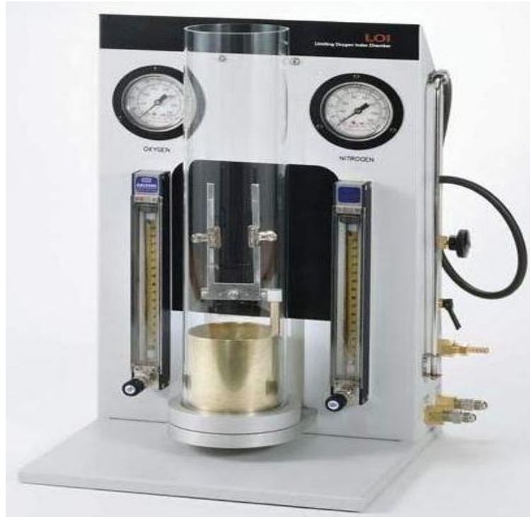
Obr. 5 Přístroj ke stanovení limitního kyslíkového čísla [3]
