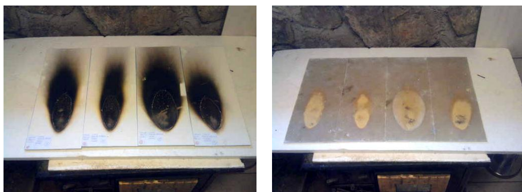
Obr. 16 Porovnání prohoření gelcoatu a pryskyřice vzorku č. 1
