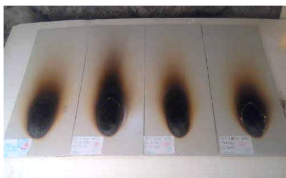
Obr. 21 Porovnání prohoření gelcoatu a pryskyřice vzorku č. 6
