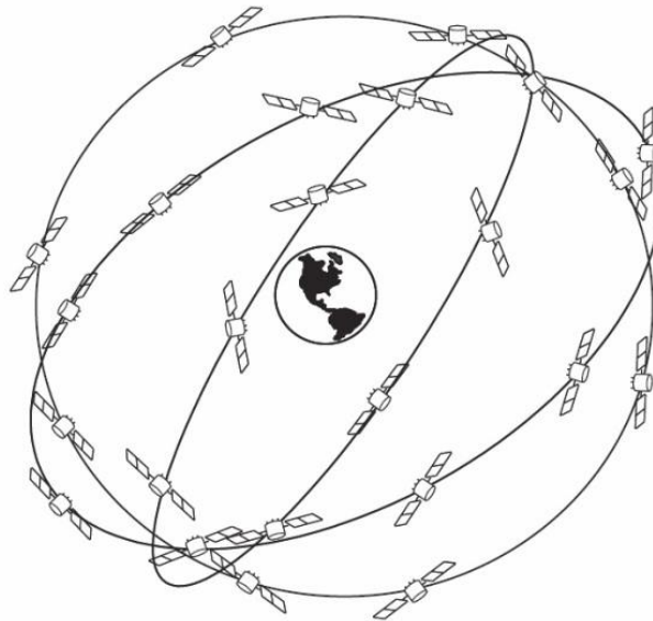
Obrázek 14 Kosmický segment GLONASS [6]
