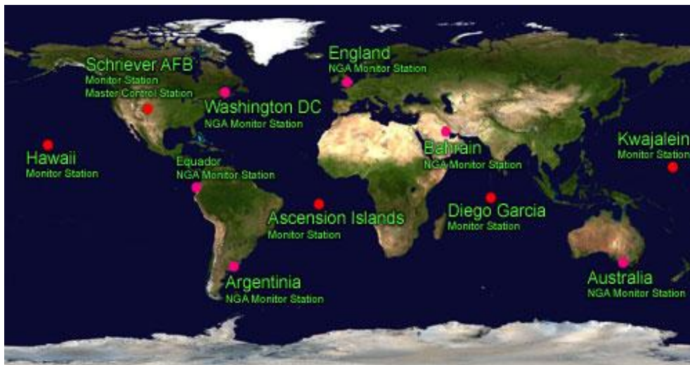
Obrázek 10 Řídicí a monitorovací stanice pozemního segmentu GPS [8]
