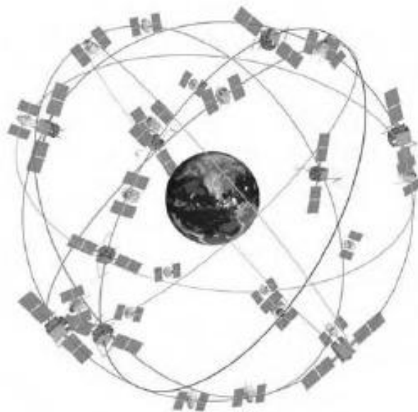
Obrázek 8 Kosmický segment GPS [6]
