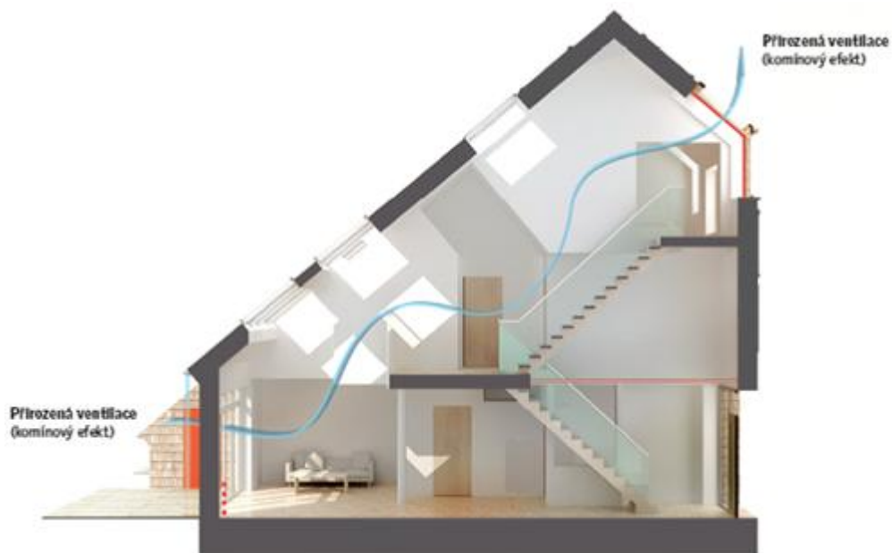
Obrázek 35 – princip přirozené cirkulace [39]
