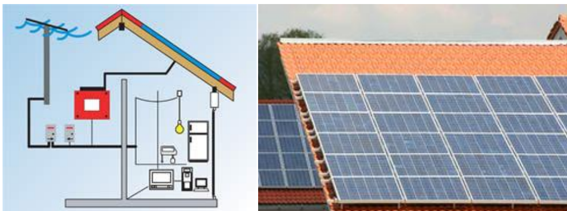
Obrázek 20 – schéma zapojení systému dodávající energii do sítě a umístění panelů [30]
