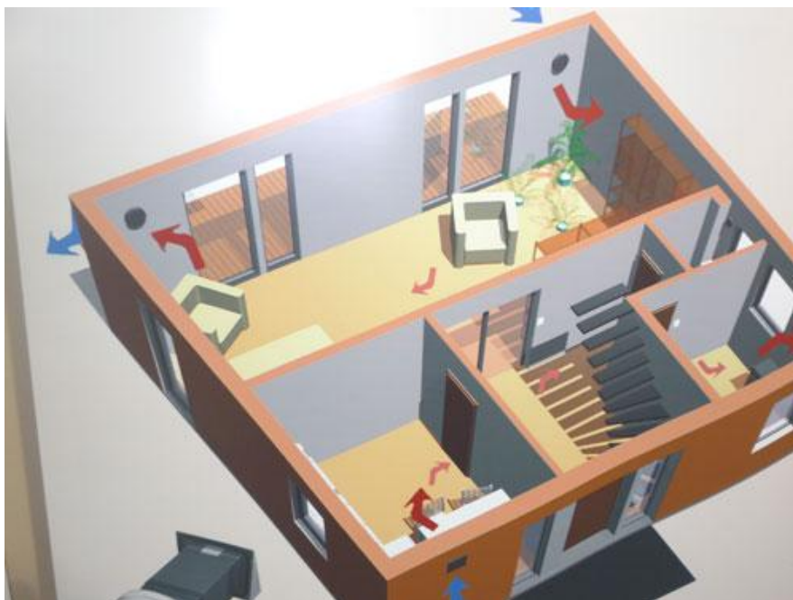
Obrázek 18 – princip invertní rekuperace [29]
