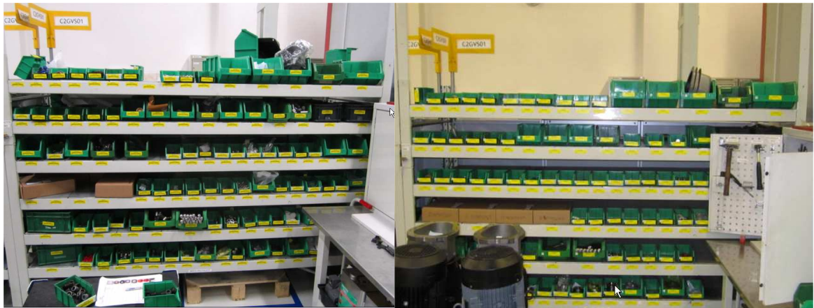
Obr. 29 Stav před a po revizi a redukci binů a 5S [13].
