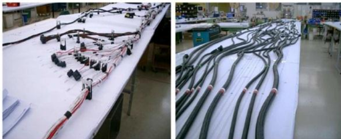
Obr. 12 Elektrické rozvodové systémy pro autobusy (Forschner, 2008)
