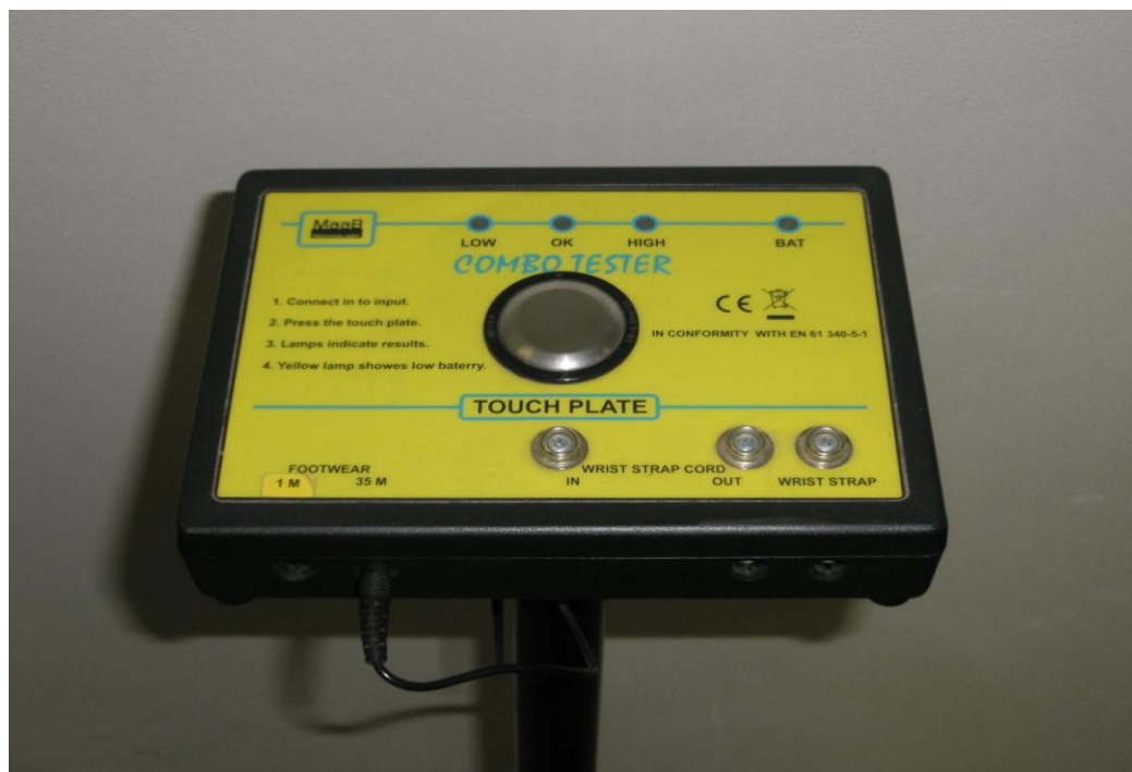
Obrázek 11: Přístroj pro zjišťování vodivosti obuvi (vlastní zpracování)
