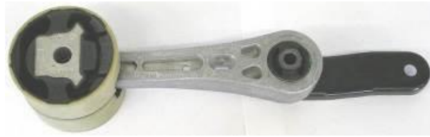
Obr. 18. Momentová vzpěra a její uložení
